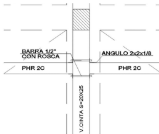
Detalle No. 3 Esquema donde se presenta soporte del perfil en laterales de la viga cinta en cubierta Bloque 1 y 2.
