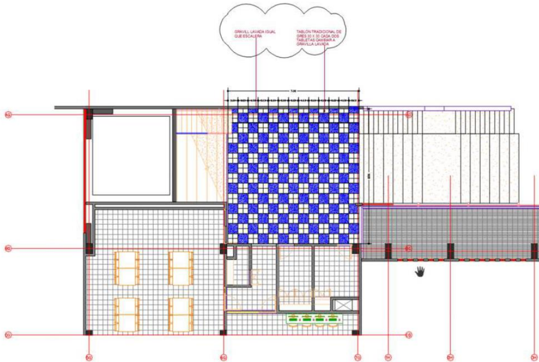
Ilustración 09. Detalle de piso ajedrezado en nivel + 4.2m
